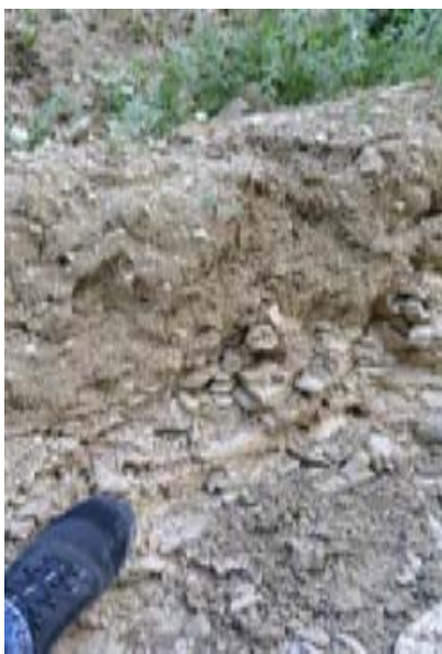
Figura 24: Marne con Cerroghna interessate da un elevato clivaggio
